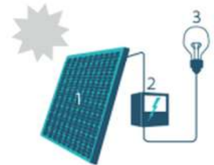
1. Zonnepaneel | 2. Omvormer | 3. Elektrische toestellen
